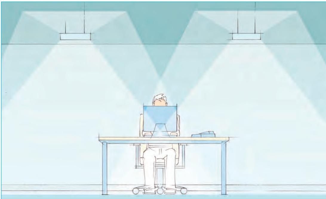
Abbildung 25 Beispiel für Direkt-/Indirektbeleuchtung
