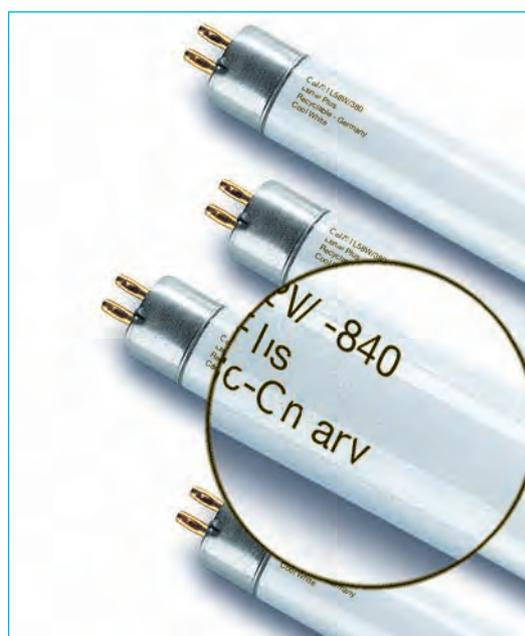
Abbildung 13 Kennzeichnung der Lampen hinsichtlich Farbwiedergabe und Lichtfarbe durch dreiziffrigen Code. Der Code 840 bedeutet: 8 – Farbwiedergabeindex  $R_a \approx 80$  (gute Farbwiedergabe), 40 – Farbtemperatur 4000 K (neutralweiße Lichtfarbe)
