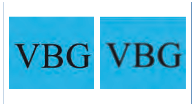
Abbildung 11: Darstellung auf einem LCD-Bildschirm: links in physikalischer, rechts in kleinerer Auflösung
